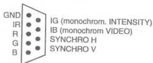
Rysunek 1.7. Schemat gniazda wyjściowego karty EGA
